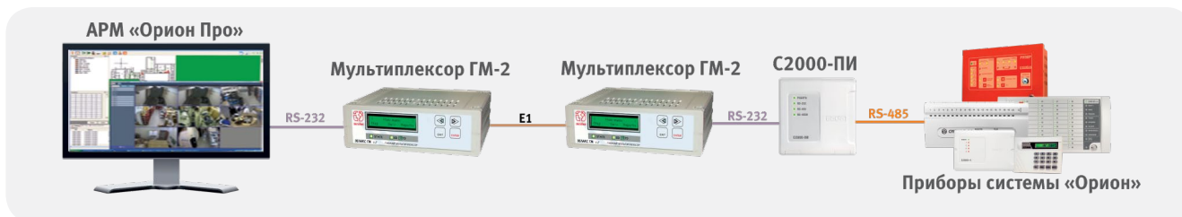
Рисунок 92. Структурная схема использования мультиплексора «ГМ-2» с АРМ «Орион»/«Орион Про»
